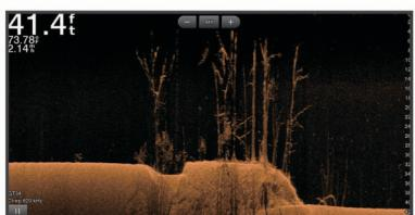
Tradisjonelle svingere sender ut en konisk stråle. Garmin ClearVÜ søkerørs teknologien sender ut to smale stråler med lignende form som strålen i en kopimaskin. Disse strålene gir et tydeligere, fotografisk bilde av det som befinner seg under båten.
