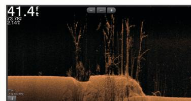
Tradisjonelle svinger sender ut en konisk stråle. Garmin ClearVÜ søkerørt sender ut to smale stråler med lignende form som strålen i en kopimaskin. Disse strålene gir et tydeligere, fotografisk bilde av det som befinner seg under båten.
